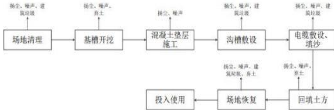
图4-1 架空线路施工工艺流程图
